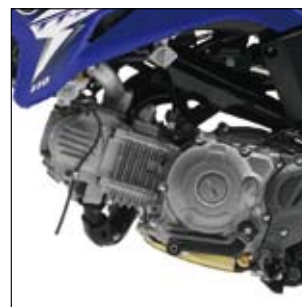
クリーンでパワフルな4ストローク空冷単気筒エンジンに4速ギアを装備。
