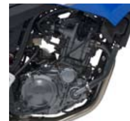
コンパクトな660ccエンジンを フュエルインジェクションでコントロール。
