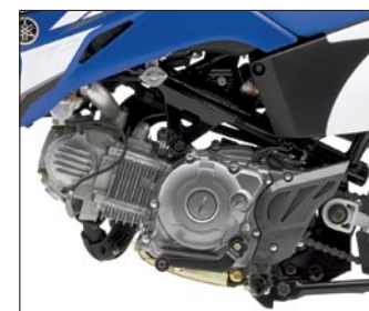
クリーンでパワフルな4ストローク空冷単気筒エンジンに4速ギアを装備。
