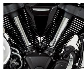
強大なパワーを生み出す、美しく磨き上げられた空冷4サイクルOHVのVツインエンジン。
