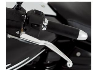
新搭載のアシスト&スリッパークラッチは、クラッチレバーの操作荷重を現行比で約20%低減、市街地走行での疲労を軽減し快適性が向上。
