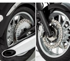
前後のブレーキが連動し、最適な制動力を發揮するUBS(Unified Brake System)を採用。
