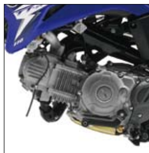
クリーンでパワフルな4ストローク空冷単気筒エンジンに4速ギアを装備。
